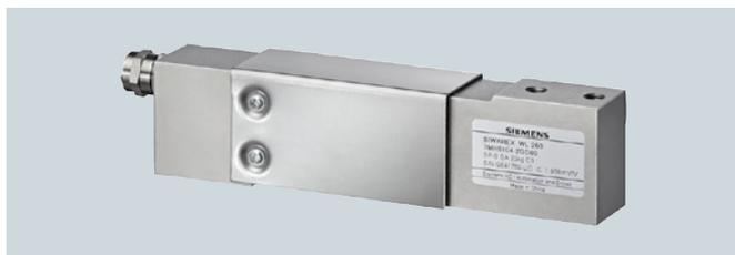
该称重传感器适用于带一个称重传感器的中型台秤（最大平台尺寸 400 x 400 mm），并适用于最大刻度间隔  $n_{\max} = 3000$  d 的 III 类中等精度称重衡器。
