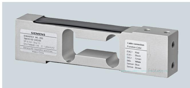
该称重传感器适用于带一个称重传感器的小型台秤（最大平台尺寸 400 x 400 mm），并适用于最大刻度间隔  $n_{\max} = 3000$  d 的 III 类中等精度称重衡器。
