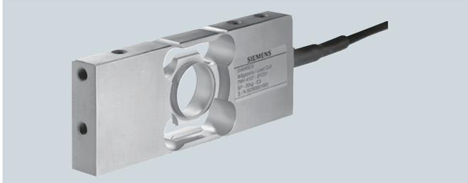
单点式称重传感器 SIWAREX WL260 SP-S SB 适用于最大台面尺寸为 350 x 350 mm 的平台秤应用。传感器具有 Class III 计量认证，可以用于贸易结算，分度值  $n_{\max}$  为 3000d。
