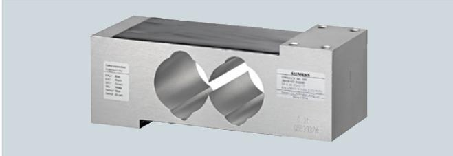
该称重传感器适用于带一个称重传感器的中型台秤（最大平台尺寸 600 x 600 mm），并适用于最大刻度间隔  $n_{\max} = 3000$  d 的 III 类中等精度称重衡器。
