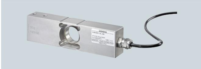
单点式称重传感器 SIWAREX WL260 SP-S SC 适用于最大台面尺寸 800 x 800 mm 的平台秤应用。传感器具有 Class III 计量认证，可以用于贸易结算。最大检定分度  $n_{\max}$  为 4000d。并且可选 C4 MR 型，分辨率高达  $Y = 40000$ ，可用于高精度测量应用。
