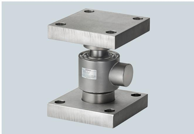
用于 SIWAREX WL270 称重传感器的自定位安装板，配有上下安装板和压头。适用于安装在料仓秤，平台秤、罐秤和汽车衡。
